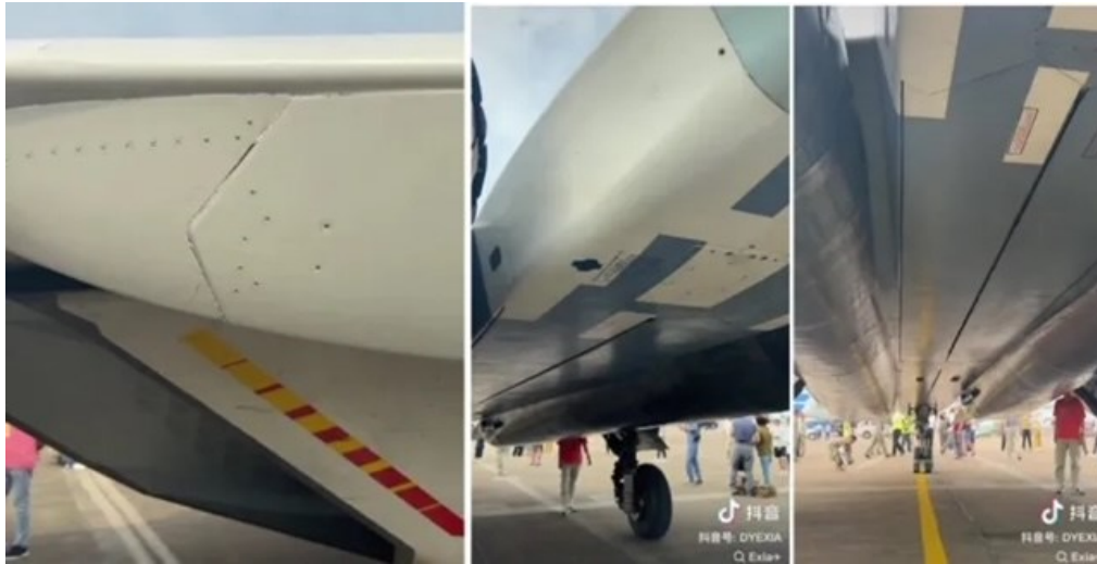
Imaginea 6 - Sursa: https://idr.w.org/russias-su-57-felon-fighter-jet-faces-criticism-at-airshow-china-2024-over-quality-issues/ (Calitatea proastă a construcției Sukhoi Su-57 Felon vizibilă clar la show-ul aerian chinezesc Zhuhai din 2024).
